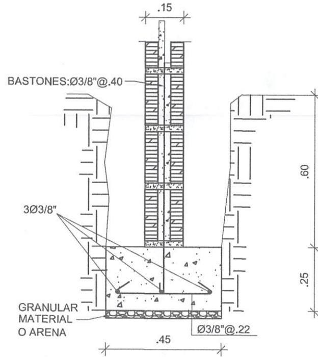
**Zapata de Muro de 0.15**
