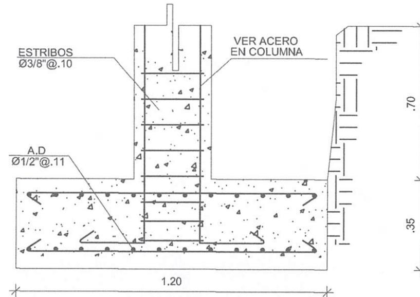
**Zapata de Columna Z1-C1**
