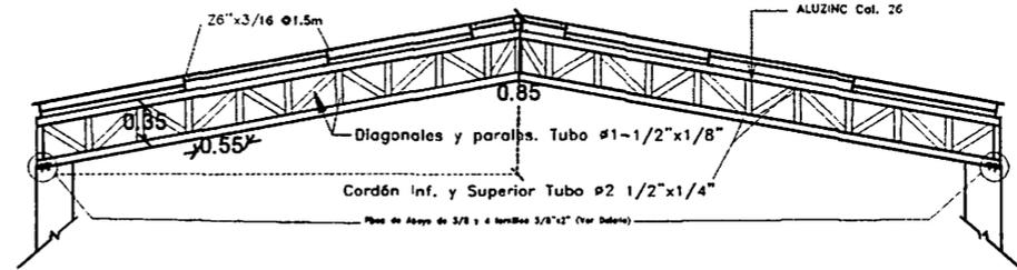
SECCIÓN A DE TECHO METÁLICO
