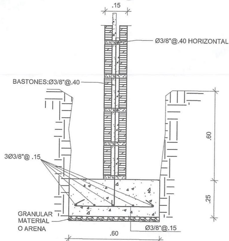
**Zapata de Muro MC**
