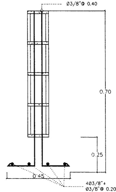
1 SECCION ZAPATA MURO
