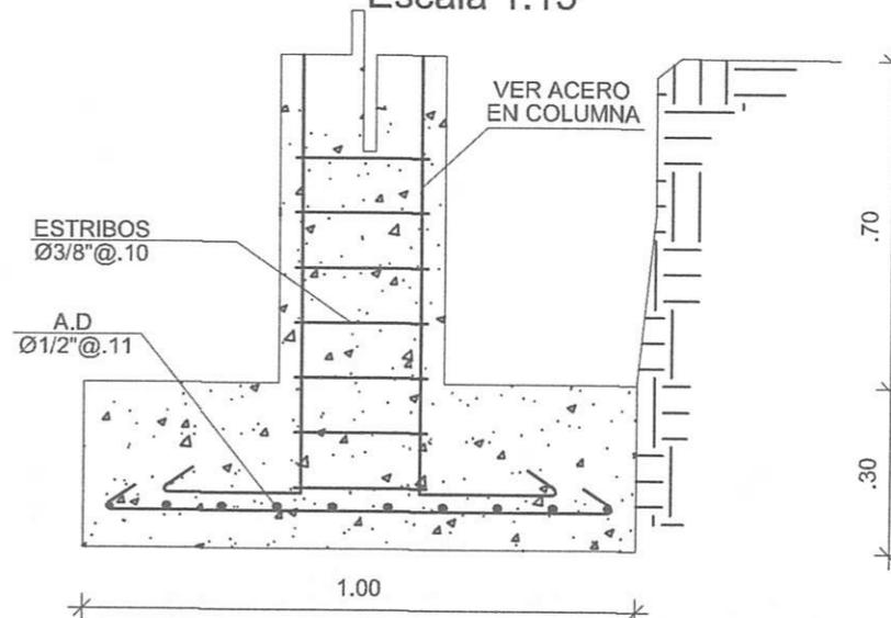
**Zapata de Columna Z2-C2**
