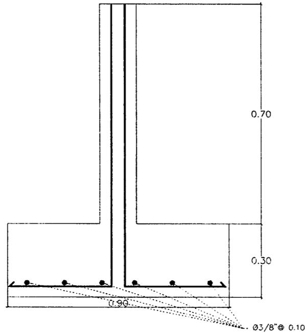
1 SECCION ZAPATA Z1
